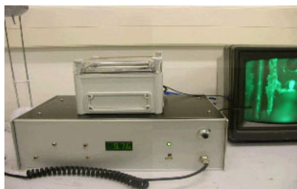
Рис. 3. Осмометр в видеовизуализации – разработка фирмы "Otago Osmometers"
