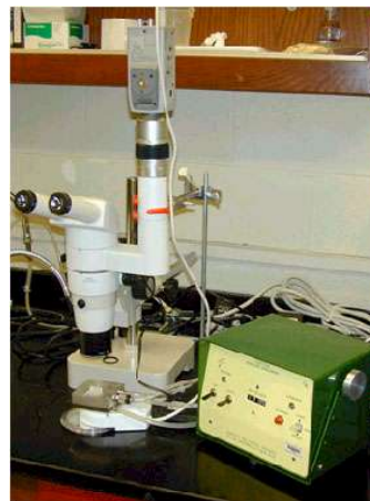
Рис. 1. Clifton Nanoliter Osmometer под объективом бинокулярного микроскопа (Environmental Institute of Houston)
