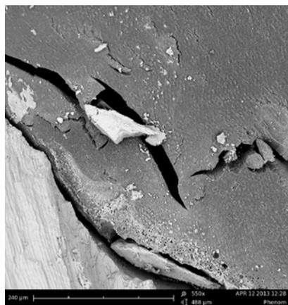
Рис. 5. Растровая электронная микроскопия (JEOLJSM-6380LV) границы эмаль-композит (нарушение герметичности, когезионные переломы в толще композита)
