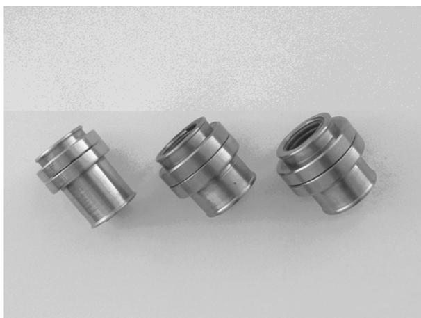
Рис. 1. КСК трех типоразмеров (слева направо 28, 31 и 33)
