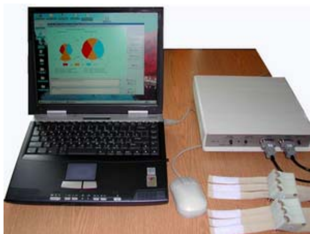
Рис. Общий вид АПДК: ноутбук, аналогово-цифровой блок, два комплекта трехточечных датчиков пульса
